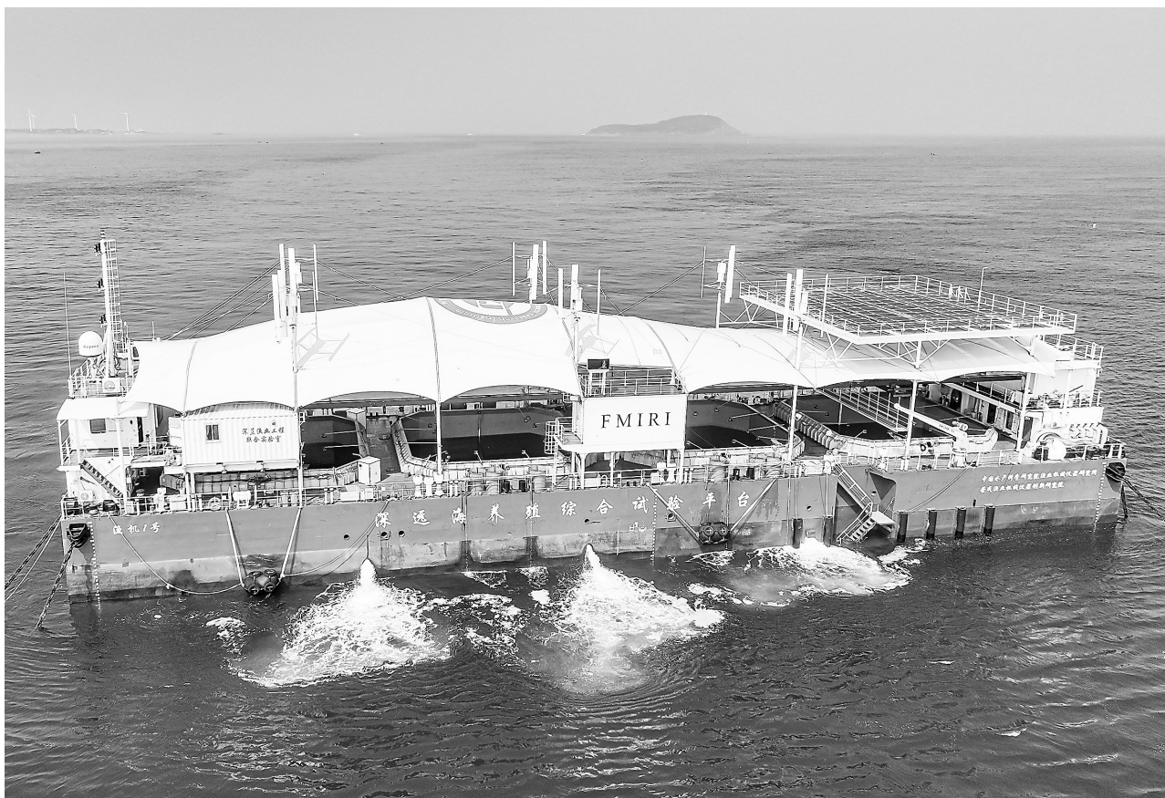
近日，“渔机1号”深远海养殖综合试验平台在山东省荣成市北部海域成功布放并投入运营。这是全国首座集深远海养殖新品种开发、工业化养殖模式研究及试验观测等多功能于一体的封闭式舱养系统综合试验平台，养殖水体达5000立方米，能够满足多样化的深远海养殖实验需求。
