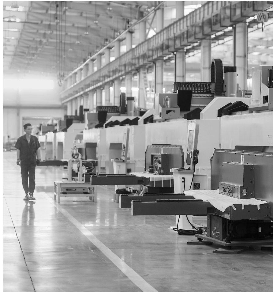
这是近日在湖北鄂州华工科技智能制造产业园内拍摄的三维五轴激光切割智能装备。
