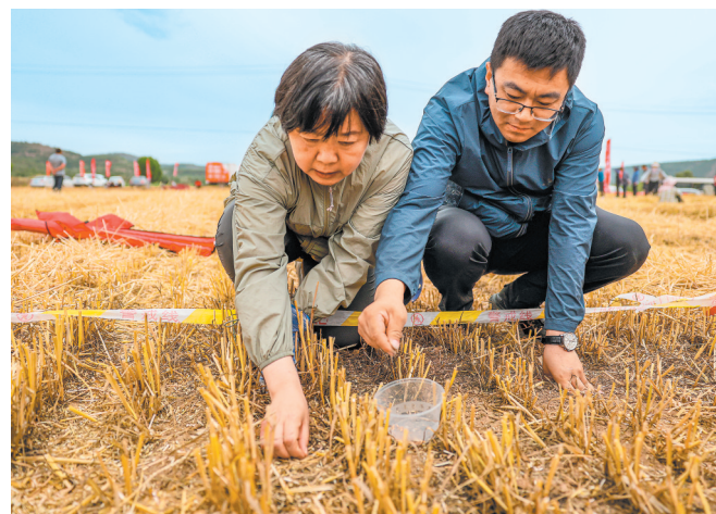
全省粮食作物机收减损技术暨机收大比武考核组成员测量作业区内地面掉落籽粒。
