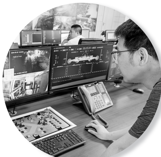
在山西省霍州市的山西焦煤集团李雅庄煤矿，综采队技术员在井上控制井下割煤机。
