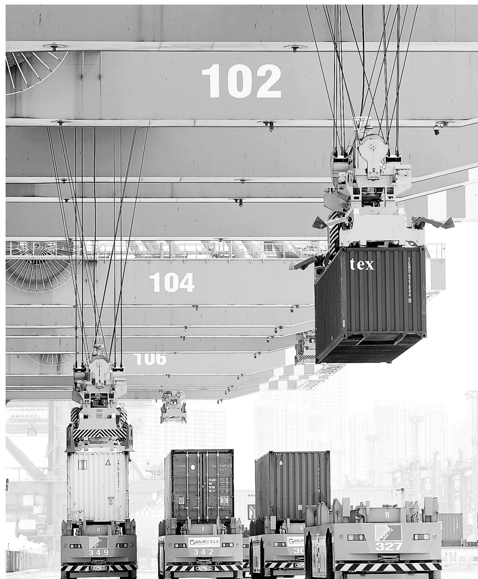
货轮在山东港口青岛港全自动化码头装卸集装箱。 新华社发
