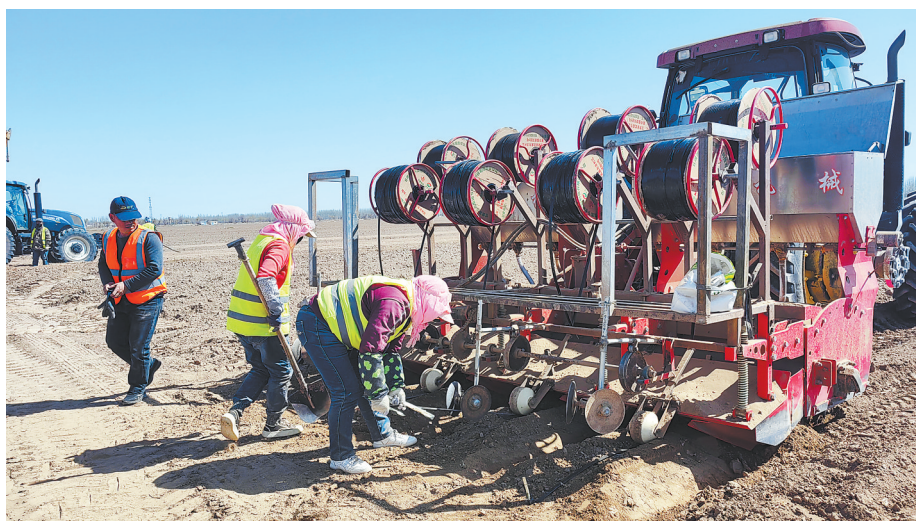
黄羊河农场职工在调试滴灌机设备。新甘肃·甘肃日报记者 王朝霞
