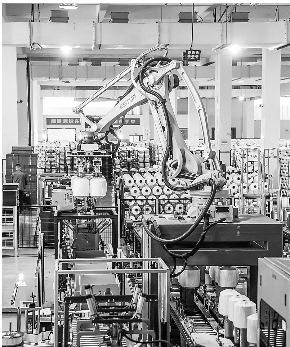
近日,在位于浙江省绍兴市柯桥区的绍兴诚邦高新纤维科技有限公司智能包装车间内,自动化机械臂正在打包、搬运产品。 新华社发
