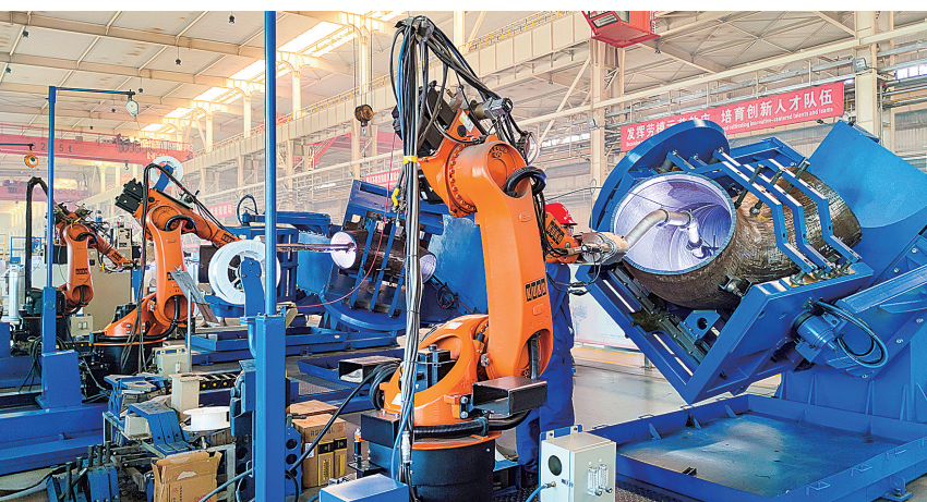
兰石重装公司焊接数字化车间在作业的焊接机器人。
