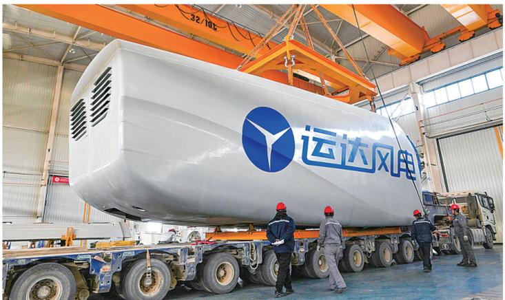
甘肃省云风智慧风电设备有限公司(运达股份西北总部)工人正将风电主机装车运输。谢沛宏
