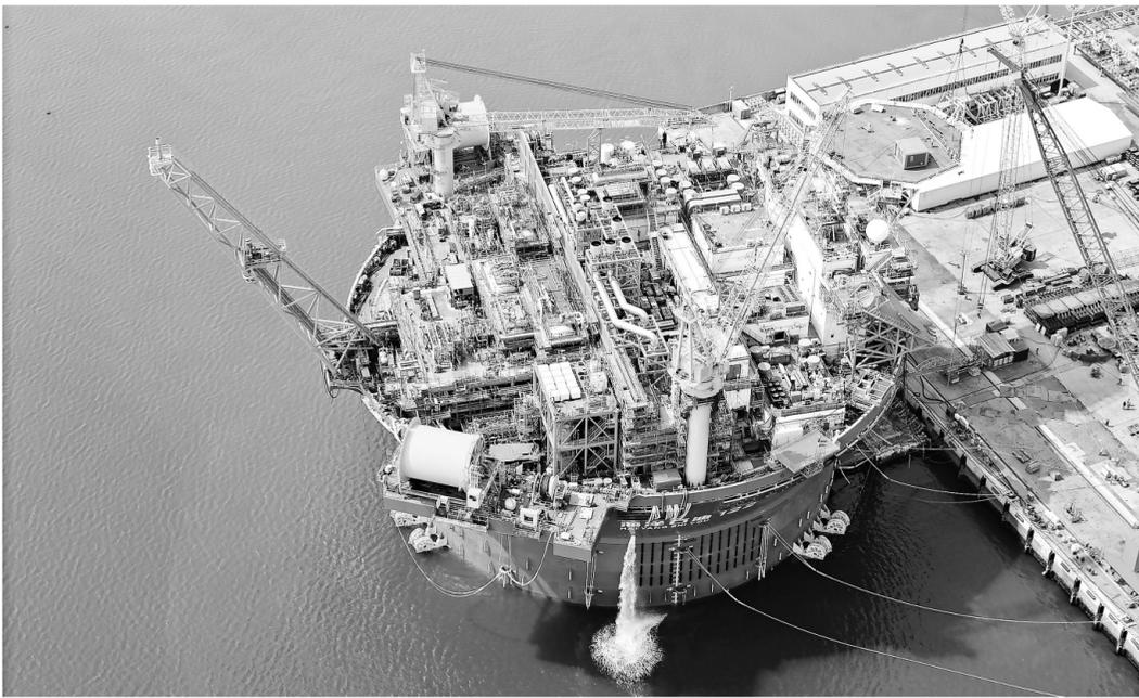
4月7日,“海洋石油122”浮式生产储卸油装置(FPSO)在海油工程青岛场地进行海上倾斜试验及调试。当日,由我国自主设计建造的亚洲首艘圆筒型“海上油气加工厂”——“海洋石油122”浮式生产储卸油装置(FPSO),在海油工程青岛场地进行海上倾斜试验及调试,为项目年内投产奠定基础。
