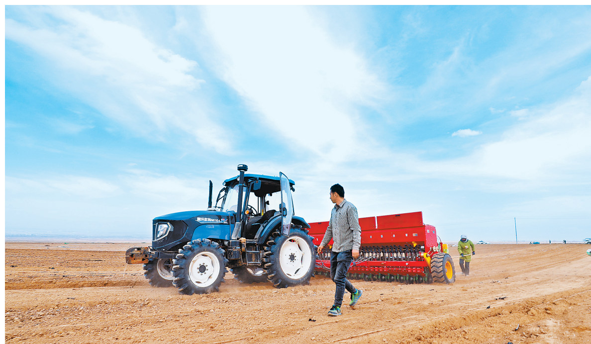
近日,张掖市甘州区花寨乡金花寨种植专业合作社小麦种植基地里,农户正在使用北斗导航自动驾驶拖拉机牵引的播种、施肥、覆膜、滴灌带铺设为一体的播种机械进行小麦播种。
