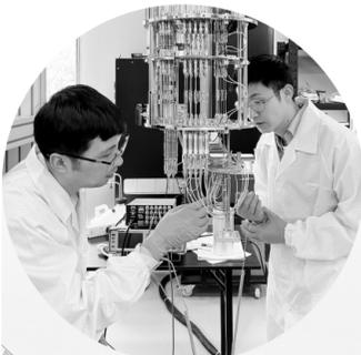
在位于苏州的量子科技长三角产业创新中心，科研人员对量子计算机进行量子芯片的安装调试(资料照片)。
