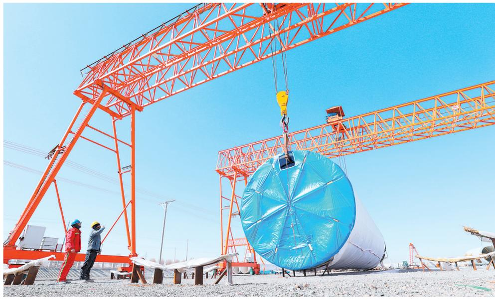
近日，在高台县南华工业园区的中船风电叶片塔筒生产基地，工人们吊装风力发电机组塔筒。新甘肃·甘肃日报通讯员 王将
