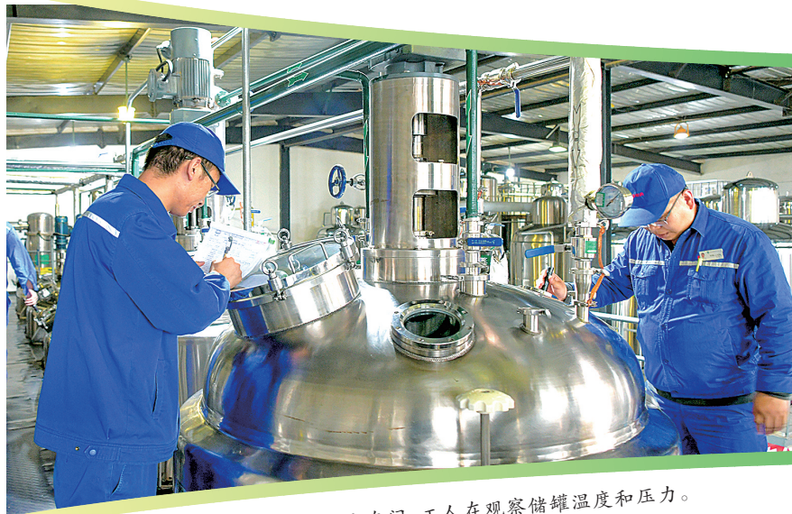
在甘肃普安制药股份有限公司提取车间,工人在观察罐温度和压力。
