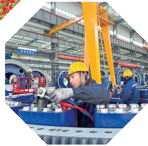
酒泉经开区甘肃明阳智慧能源有限公司生产车间,工人正在进行风机轮毂装配。董文龙
