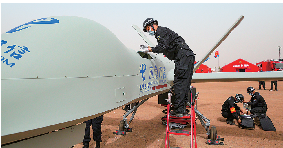
无人机应急通信基站可为极端情况下提供应急通信联络。
