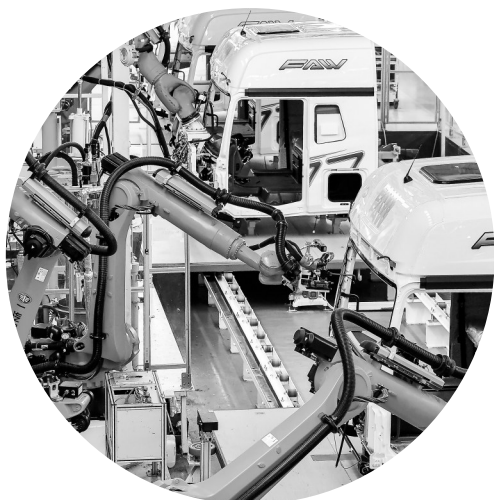
在位于吉林长春的一汽解放J7智能工厂内,智能机器人进行车辆玻璃装配及涂胶工作。
