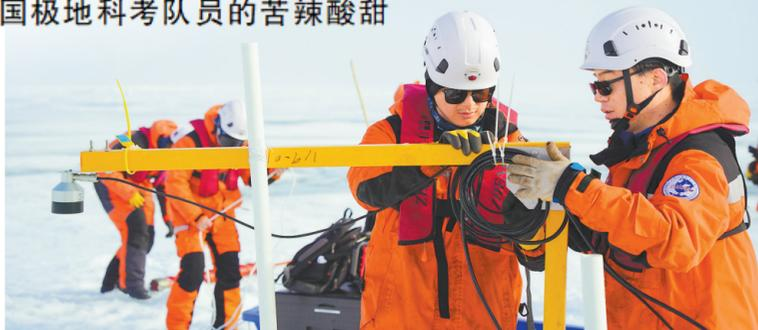
8月12日,科考队员在布放海冰物质平衡浮标。当日,中国第13次北冰洋科学考察队乘坐“雪龙2”号极地科考破冰船航行至北纬81度附近海域,正式开始海冰综合调查作业。
