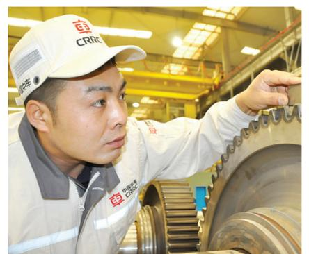
甘肃省技术能手、中国中车技能专家、中车兰州公司高级技师张向东正在测量机车车轮尺寸。
