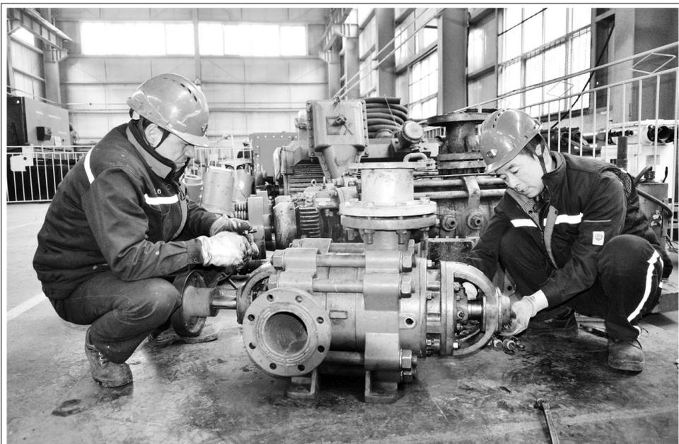
连日来,华亭煤业公司东峡煤矿不断在设备检修、维护、保养工作上动脑筋、想办法,严格按照检修标准执行,完善设备检修台账,对检查中发现的问题,安排时间逐项进行整改,保证了各类机电设备安全经济运行。图为该矿机电队职工正在检修水泵。 白银宝 摄
