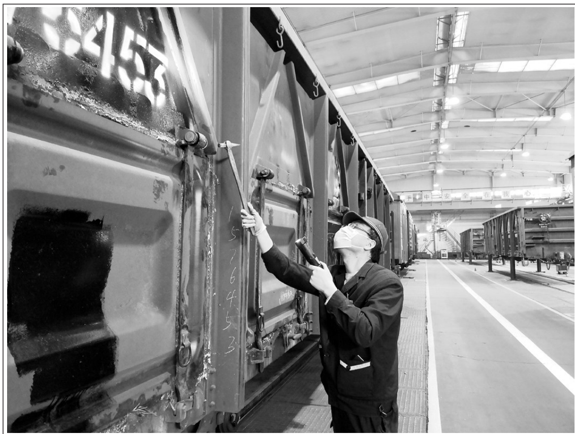
新年伊始,兰铁兰州西车辆段强化安全质量管理,丰富摄像手电、作业记录仪等技防手段,压紧压实“三检一验”关口,为全年货车安全生产开好头、起好步。图为该段验收员正在检查敞车下侧门安装状态。袁陇来 摄
