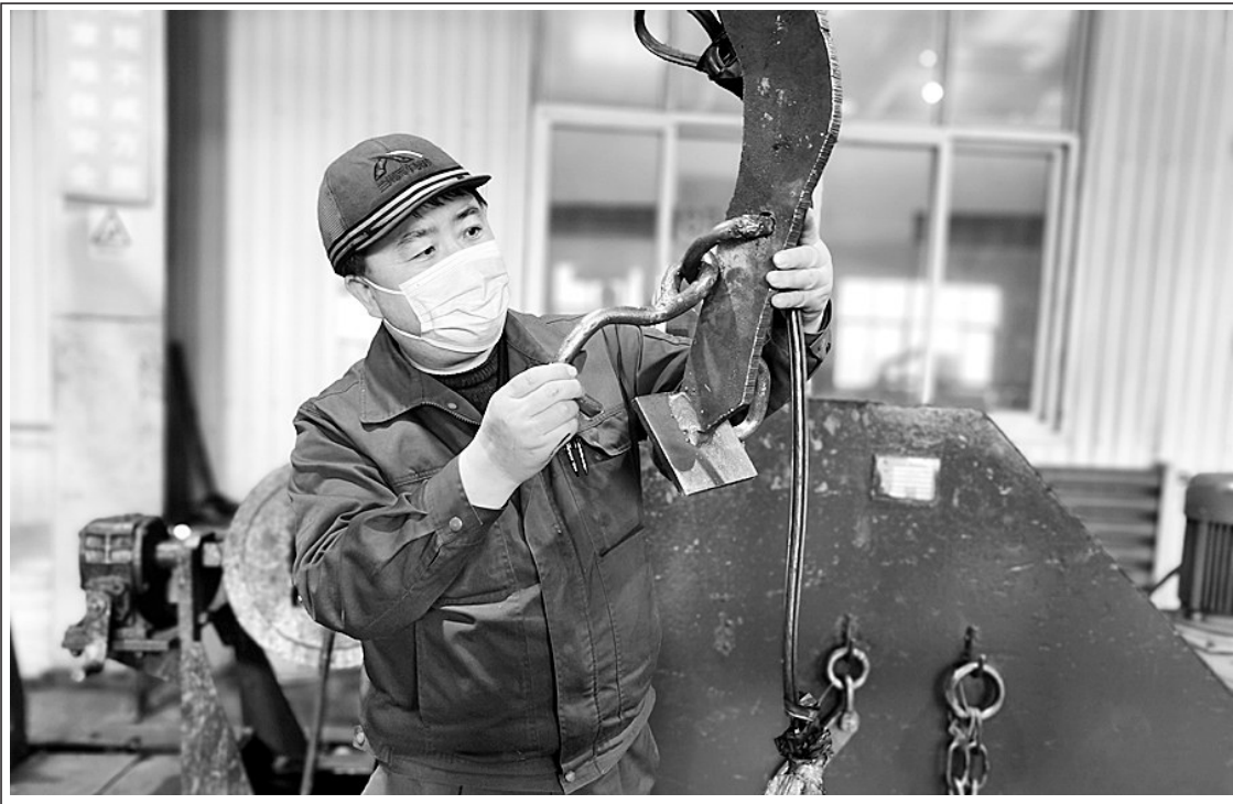
兰铁兰州西车辆段开展起重机械专项整治行动,严格落实吊具日检查、月探伤等管理制度,全力以赴织密岁末安全生产防护网。图为修配车间技术人员正在检查天车吊具状态。袁晓来 摄
