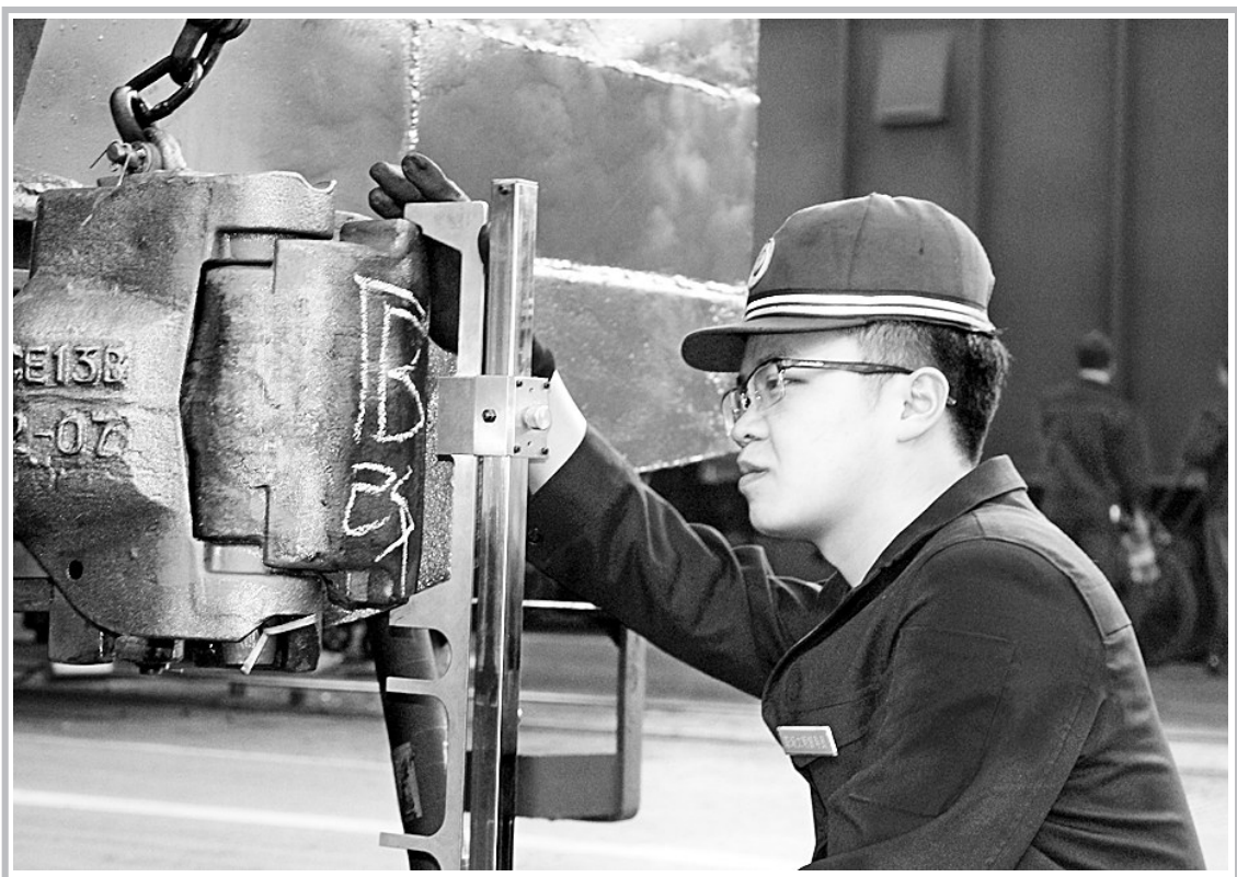
入暑以来,兰铁兰州西车辆段推行等级互控管理新模式,强化对安全质量关键环节的层级把关、有效控制,确保配件合格,车辆优质。图为该段职工正在精心检测车钩高度。袁陇来 王逸君 摄
