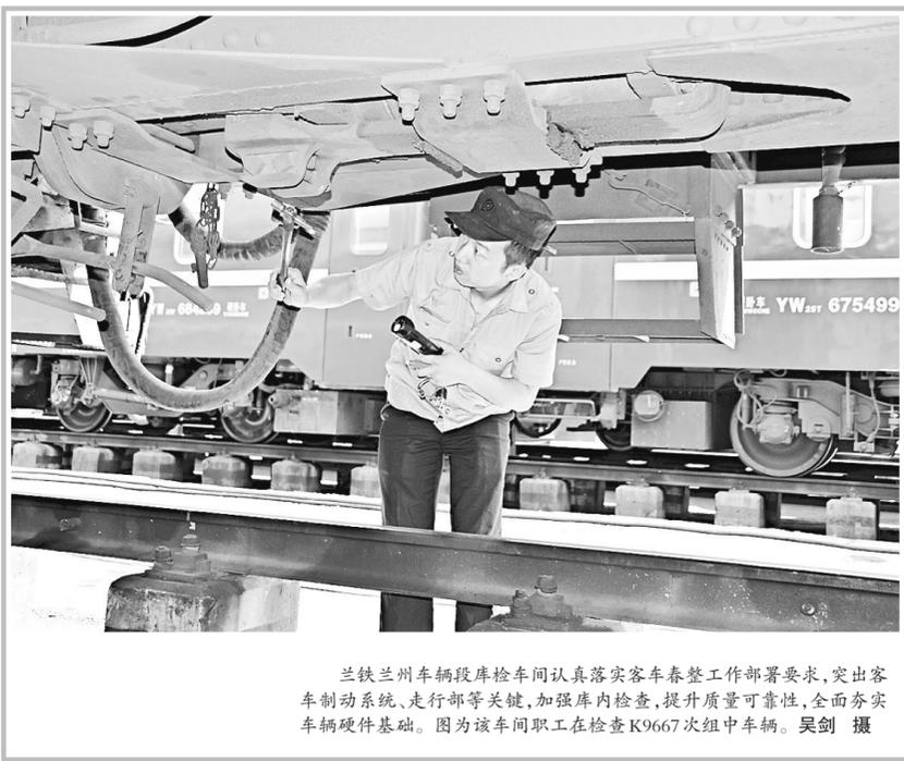
兰铁兰州车辆段检修车间认真落实客车春整工作部署要求,突出客车制动系统、走行部等关键,加强库内检查,提升质量可靠性,全面夯实车辆硬件基础。图为该车间职工在检查K9667次组中车辆。吴剑 摄
