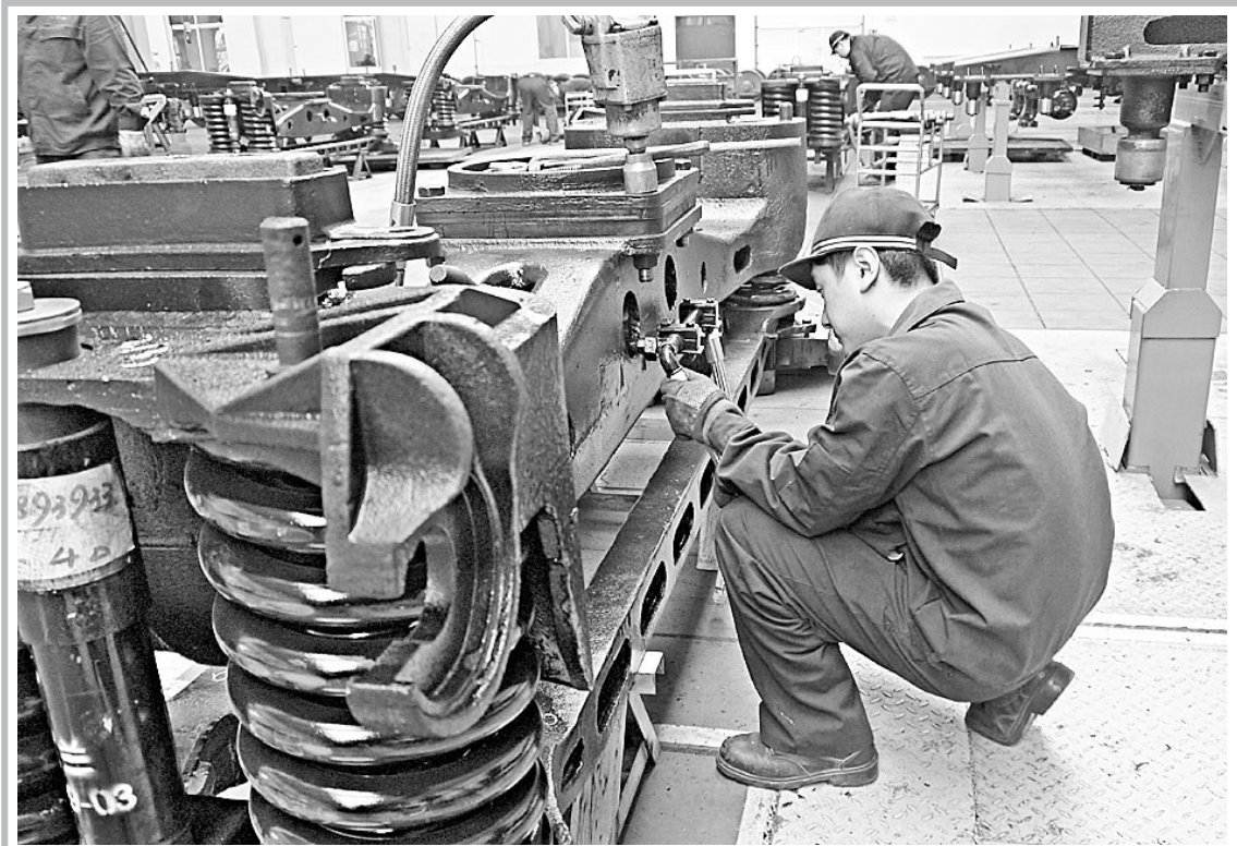
兰铁兰州车辆段高度重视源头质量,加强段修客车转向架、制动系统等重点部位的检修,严格段修质量检查验收过程控制,从源头上消除隐患,杜绝源头配件“错装、漏装”,确保新修竣工车辆状态良好,符合上线运行标准。图为近日该段检修车间职工在组装转向架。 吴剑 摄
