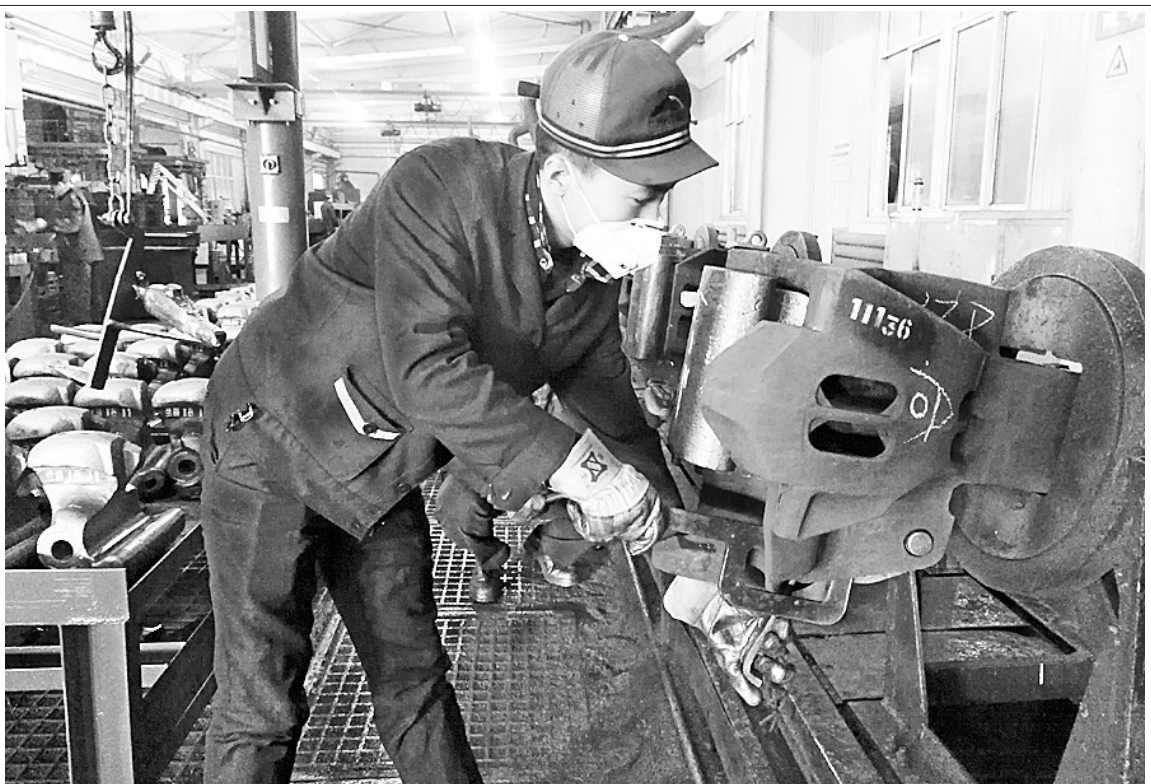
为提升冬季货车检修质量,兰铁兰州西车辆段细化关键部件检修工艺,补强质量标准及措施,以部件优质提升整车性能,精细检修确保货运安全。图为该段青工正在对17型车钩进行二次防跳试验。袁陇来 郑丽红 摄
