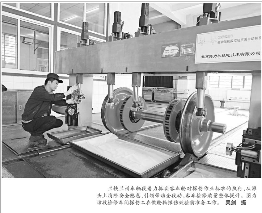
兰铁兰州车辆段着力抓实客车轮对探伤作业标准的执行,从源头上消除安全隐患,引领带动全段动车、客车检修质量整体提升。图为该段检修车间探伤工在做轮轴探伤检验前准备工作。吴剑 摄
