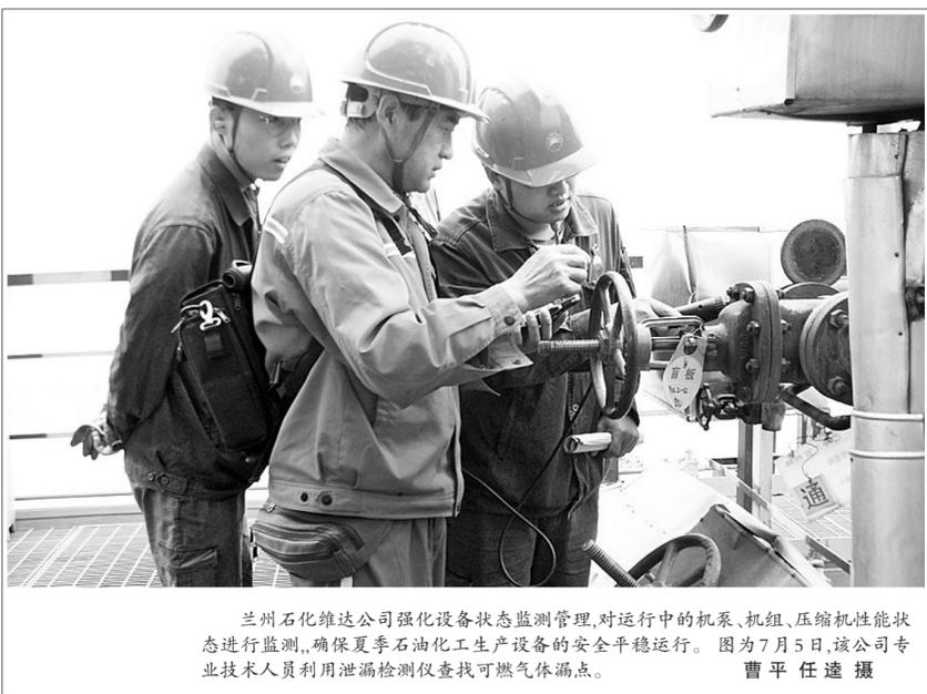
兰州石化维达公司强化设备状态监测管理,对运行中的机泵、机组、压缩机性能状态进行监测,确保夏季石油化工生产设备的安全生产平稳运行。图为7月5日,该公司专业技术人员利用泄漏检测仪查找可燃气体漏点。
