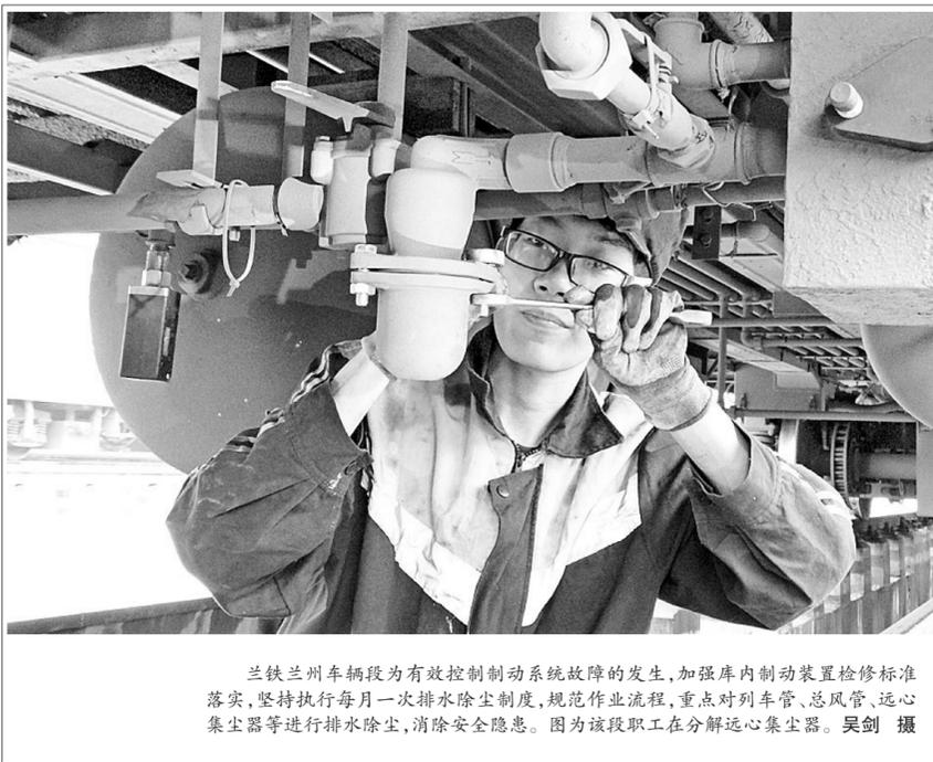
兰州兰州车辆段为有效控制制动系统故障的发生,加强库内制动装置检修标准落实,坚持执行每月一次排水除尘制度,规范作业流程,重点对列车管、总风管、远心集尘器等进行排水除尘,消除安全隐患。图为该段职工在分解远心集尘器。吴剑 摄
